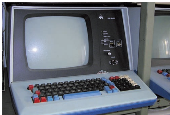
Obr. 3 Vyhodenie 16-bitového mikropočítača SM 50/50-1 ako inteligentný terminál. Pridaním samostatného boxu s dvoma mechanizmami 8" pružných diskov vznikla zostava terminálovej stanice SM 50/50-1.
