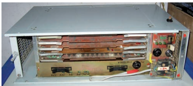
Obr. 1 Kazetové vyhotovenie mikropočítača SM 50/40-1, ktoré umožňovalo osadiť päť dosiek tejto stavebnice. Pre väčšie konfigurácie bolo možné mechanicky aj elektricky spojiť dve takéto kazety do jedného celku. Kazeta mala svoj sieťový napájací zdroj aj ventilátor.
