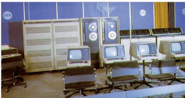
Obr. 7 Zostava 32-bitového výkonného minipočítača SMEP SM 52/12 s dvoma mechanizmami diskových pamätí 2 x 100 MB, dvoma mechanizmami 1/2" magnetických páskových pamätí a viacerými videoterminálmi. Počas Medzinárodného strojárenského veľtrhu v Brne v r. 1986 mu bola udelená zlatá medaila.
