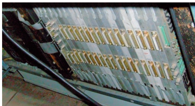
Obr. 5 Multimikroprocesorový počítačový systém MXP 16 vznikol hlavne pre potreby aplikácií spracovania obrazových informácií. Dodatočne bol využitý aj na riadenie otvorených počítačových sietí ako prepojovací uzol siete podľa X. 25.
