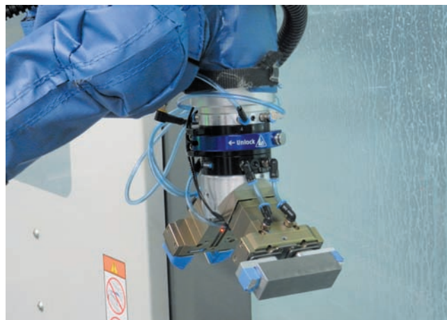
Uchopovače SCHUNK PGN plus 40-1-AS-SD na konci kolaboratívneho robota
