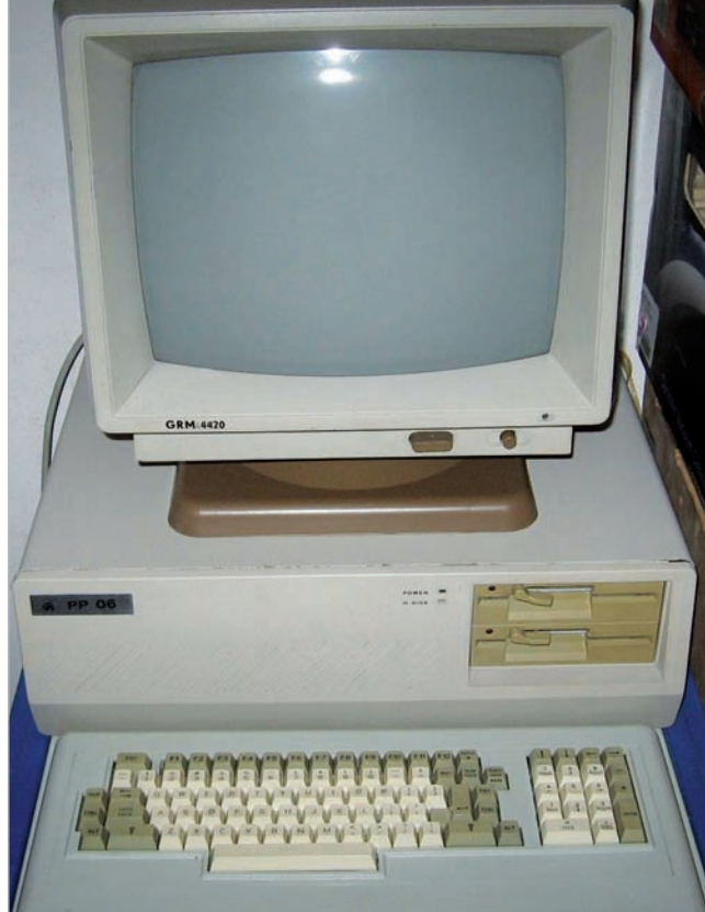
Obr. 6 16-bitový personálny počítač PP 06, kompatibilný s IBM PC. Vyrábala sa aj vo vyhotovení PP 06.3, profesionálna grafická stanica so samostatným grafickým procesorom a grafickou pamäťou a PP 06.4, laboratórny merací systém.
