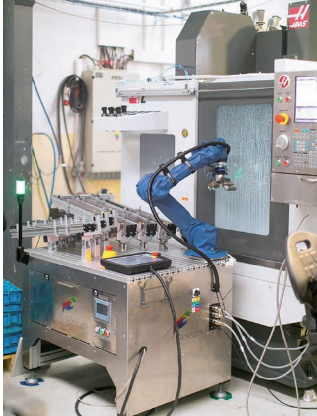
Mobilná platforma s kolaboratívnym robotom, jeho riadiacim systémom aj nadradeným PLC, ktorá sa dá veľmi jednoducho a rýchlo premiestniť k inému stroju, resp. odsunúť v prípade manuálnej výroby.
