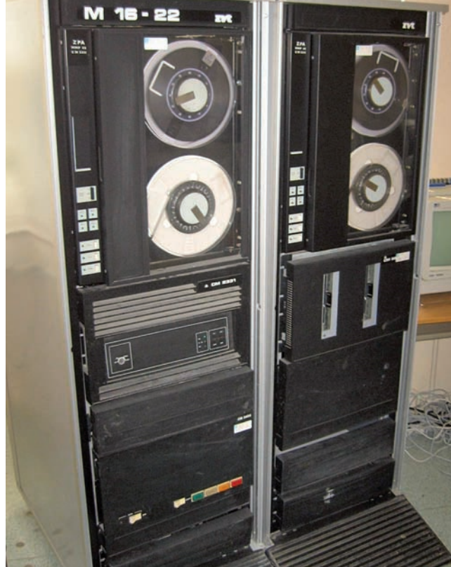
Obr. 4 Dochovaná historická rozšírená stojanová zostava počítača M 16-22 obsahujúca okrem procesora s operačnou pamäťou 512 KB s ECC tiež kazetovú diskovú pamäť, dve 1/2" magnetickej páskovej pamäte a pamäť na 8" pružných diskoch.
